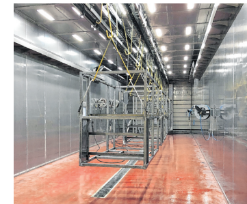
Vorbehandlung von Fertigteilen für die Pulverbeschichtung.
